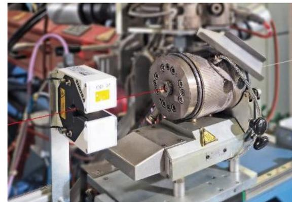
Extrusão do Isolamento do Condutor
