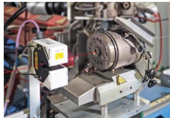
Extrusão do Isolamento do Condutor
